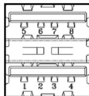
**SIM1\_2, SIM2\_2 : SIM Card Socket**
