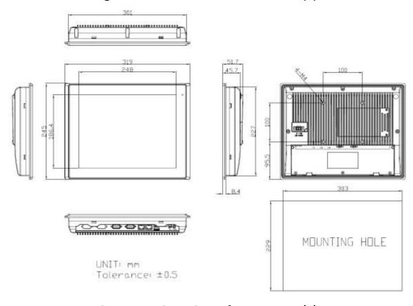
Figure 1.4: Dimensions of ARCHMI-812(P)H
