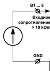
Датчики с сигналом 0 ... 20 mA (тип 4)
