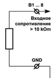
Датчики с сигналом 0 ... 10 Vdc (тип 3)
